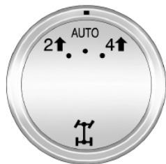
Раздаточная коробка без понижающей передачи
